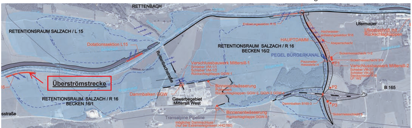
Auf dem Ausschnitt des Lageplanes sind deutlich die drei Retentionsräume zu sehen, welche Mittersill im Hochwasserfall schützen. Neben dem linken Retentionsraum „L15“ gibt es auf der rechten Seite zwei große Auffangbecken. Die Überflutung der Retentionsräume beginnt AUTOMATISCH ab einem bestimmten Pegelstand der Salzach. Dazu wurde westlich der TAL-Station der Radweg abgesenkt. Zuerst füllt sich der Retentionsraum R16/1 - ist dieser voll, beginnt das Wasser die Rettenbachstraße zu überströmen und der große Retentionsraum R16/2 hinter dem Hauptdamm wird geflutet.
